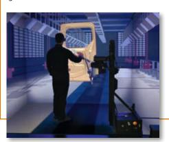
Force-Feedback, auch "Haptik" genannt, ist eine sehr effiziente Interaktionstechnologie. Es ermöglicht eine physikalische Interaktion mit virtuellen Objekten oder mechatronischen Systemen. Durch die haptische Interaktion kann der Benutzer seine handwerklichen Fähigkeiten nutzen, um Engpässe zu identifizieren sowie Abstände und mögliche Verbesserungen zu erkennen.
