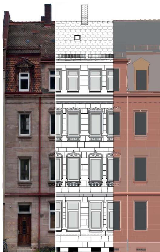
Abb. 3.1.6-5: Vergleich der Produkte: Orthophoto 2 mm (links), 2D-Aufmaß (mitte), 3D-CAD-Modell (rechts)
