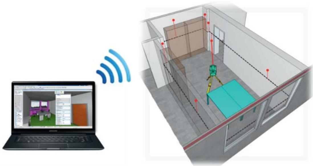
Abb. 2.5-2: Prinzip der Einzelpunkt-basierten Erfassung und Modellierung für BIM
