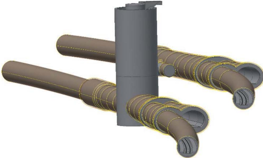
Abb. 2.2-2: BIM-Modell eines komplexen Abzweigbauwerks, das Teil der 2. S-Bahn-Stammstrecke in München ist
