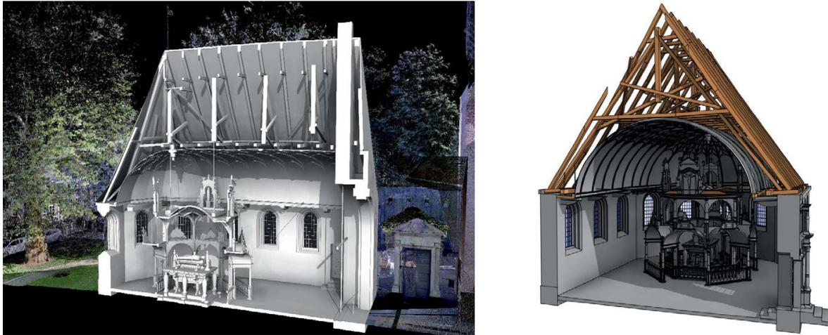
Abb. 3.1.11-4: Bauteilstrukturiertes Bestandsmodell (BIM) des Edo-Wiemken-Denkmal
