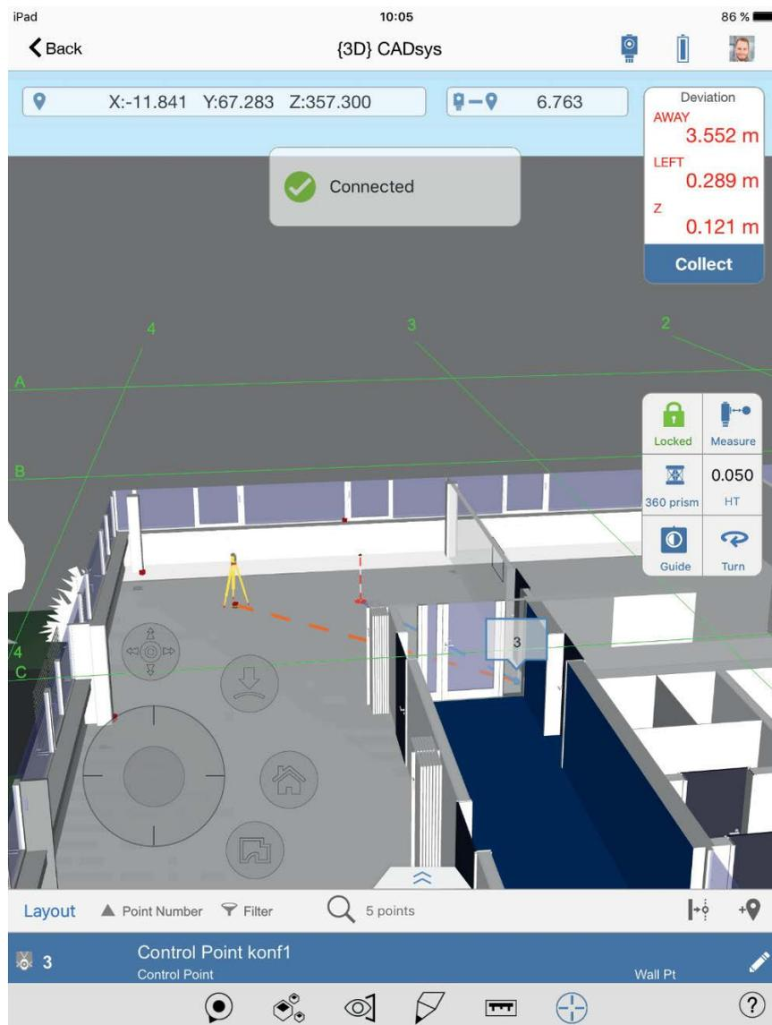
Abb. 3.1.5-2: BIM-360-Layout mit stationiertem LN-100
