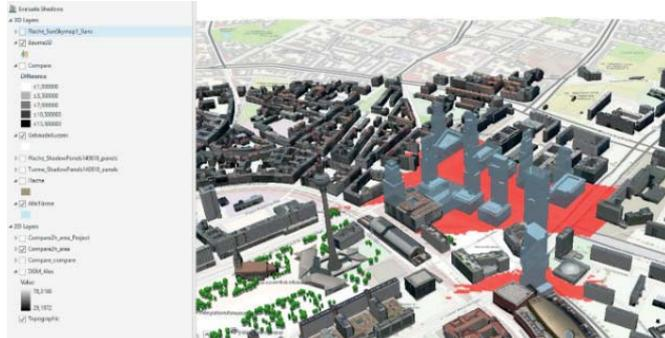
Abb. 3.2.9-4: Überprüfung des Zwei-Stunden-Schattens mit Solution Templates von Esri
