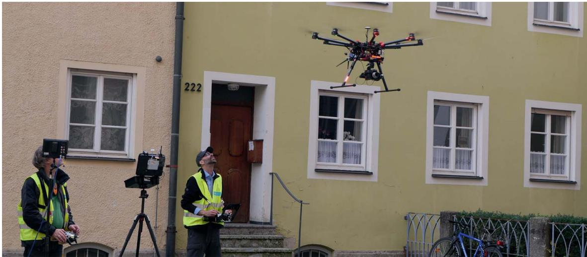
Abb. 3.1.6-1: Bestandserfassung durch Drohnenflug
