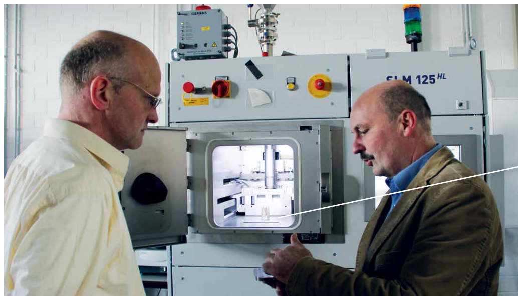
Von der Virtualität in die Realität: In der fakultätseigenen Fab Lab Versuchsfertigung werden die in 3D konstruierten und visualisierten Modelle u.a. mit einer hochmodernen Laser-Schmelz-Anlage im Materialauftragsverfahren produziert.
