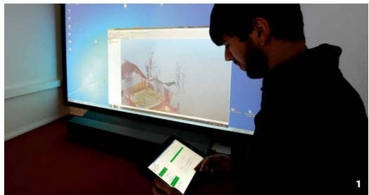
1| Mediensteuerung: Mithilfe eines Tablet-PCs ändert ein Mitarbeiter die Darstellung auf der Wall in den Splitscreen-Modus. 2| Kommando-Zentrale: Die Daten für die Projektion bereitet ein Cluster aus vier Rechnern auf, die in dem schwarzen Rack untergebracht sind. 3| High-End Stereoskopie: Die Wall mit der Software DeltaGen 10.0. Am rechten oberen Rand der Wall sieht man die Tracking-Kamera für die Interaktion mit dem projizierten Modell.
