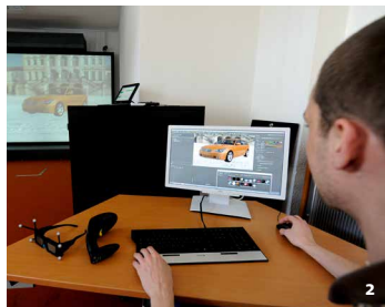
1| Mediensteuerung: Mithilfe eines Tablet-PCs ändert ein Mitarbeiter die Darstellung auf der Wall in den Splitscreen-Modus. 2| Kommando-Zentrale: Die Daten für die Projektion bereitet ein Cluster aus vier Rechnern auf, die in dem schwarzen Rack untergebracht sind. 3| High-End Stereoskopie: Die Wall mit der Software DeltaGen 10.0. Am rechten oberen Rand der Wall sieht man die Tracking-Kamera für die Interaktion mit dem projizierten Modell.
