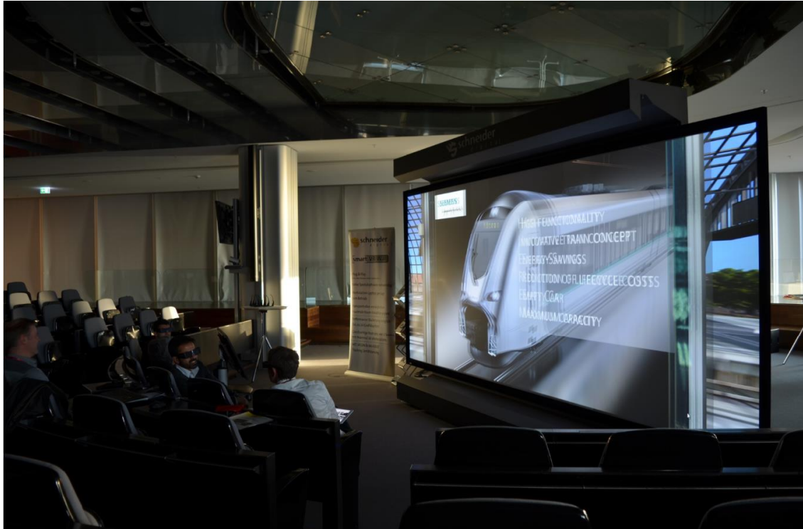
BU: Die 12 m 2 große ‚smartVR‘ PowerWall Projektionseinheit mit integrierten Front-Projektoren
